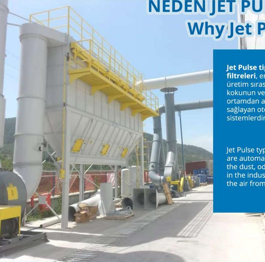
**Jet Pulse tipi toz tutma filtreleri**, endüstriyel alanda üretim sırasında ortaya çıkan tozun, kokunun ve dumanın hava emiş ile ortamdan alınarak filtre edilmesini sağlayan otomatik sistemlerdir.
