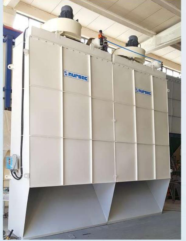
Mal alım çukuruna kamyon veya kepçe benzeri iş makinalarının ürün boşaltımı sırasında ortama yayılan tozları ve üretim sistemlerinizdeki hareketlilikten kaynaklı tozları filtrelerimizle temizliyoruz.
